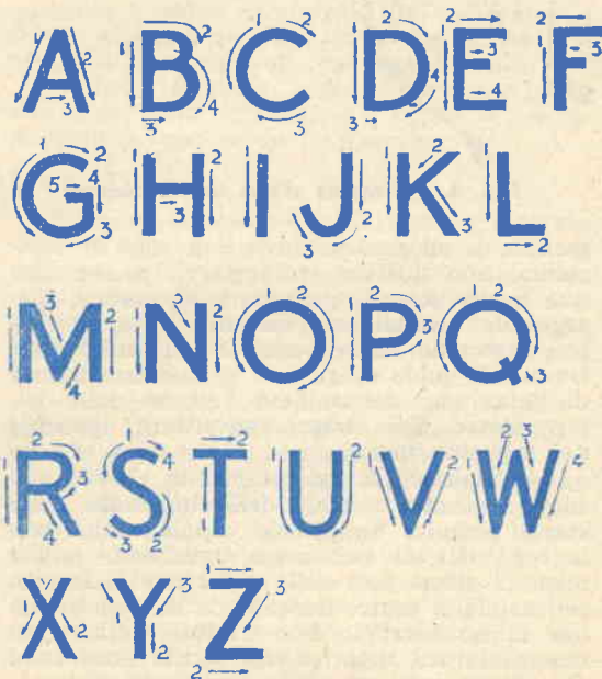
Fig. 3 - Alfabeto a caratteri tipo SCATOLA, con l'indicazione dell'ordine cronologico e del numero di pennellate.
